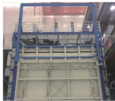
图4 大型常压热试验验证系统外观
