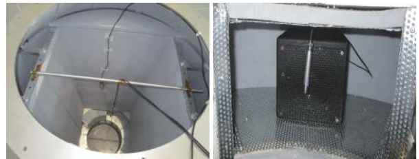
图 8 缩比模型舱内的声传感器及模拟声源
